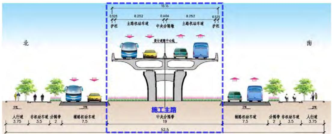
图 2-21 金湾路~进修路第二阶段施工断面示意图
