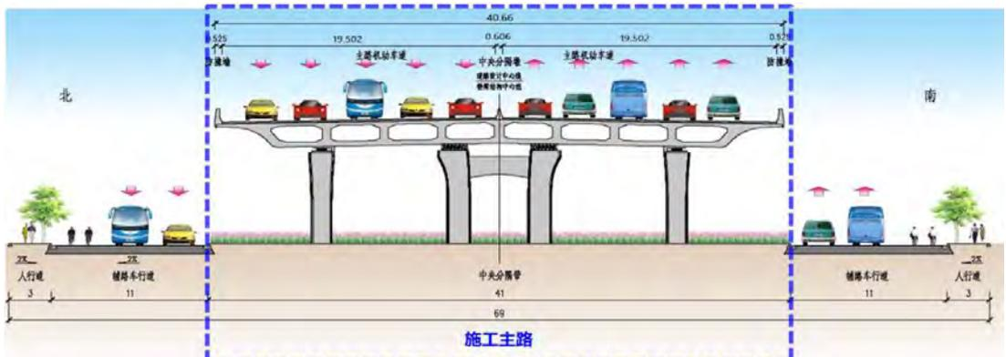
图 2-17 曙光路~头道桥第二阶段施工断面示意图
